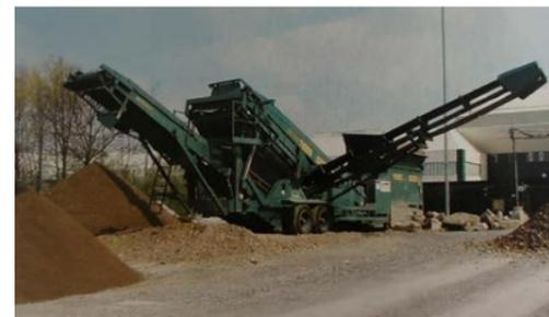
**Mobile Siebanlage.** Mit Bauschutt vermischter Kies wurde auf der Alten Messe in drei Fraktionen gesiebt: 0/10 mm musste entsorgt werden. 10/50 mm konnte direkt auf dem Gelände wieder eingesetzt werden. 50/X wurde in einer Brecheranlage verarbeitet.
