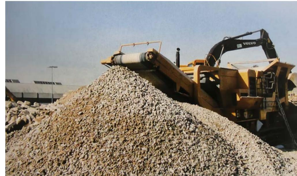
**Mobile Brecheranlage.** Stahlbetonschutt wurde gebrochen. Der Stahl wurde von Magneten heraus geholt. Zielgröße war eine abgestufte Korngrößenverteilung bis maximal 45 mm. Schadstoffgehalt und Qualität entsprachen den Anforderungen für ungebundene Tragschichten im Straßenoberbau.
